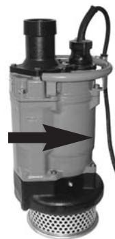
Pumpa će trznuti u smjeru suprotnom od kretanja satnih kazaljki kad se gleda odozgo, pokazujući time da se okreće u smjeru kazaljki. Ako ne, dvije od tri faze U, V, W električar bi trebao pažljivo transponirati na točki spajanja kabela pumpe na starter.
